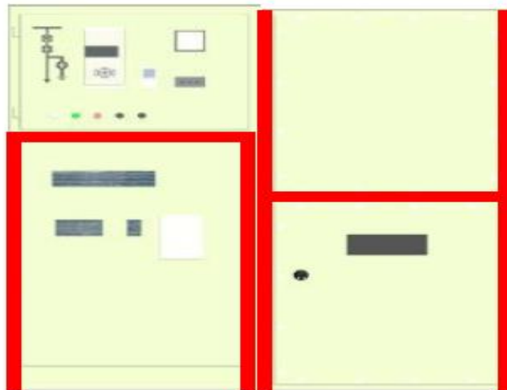
그림 5.2.2 개폐기 초음파 부분 방전 진단의 일반적인 측정 위치 (붉은 부분)
